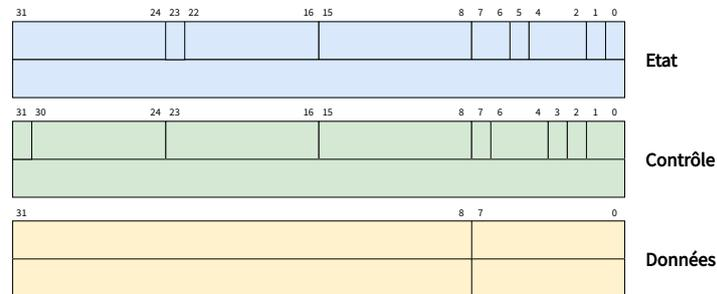
**FIGURE 2.33** – Registres d'un contrôleur
